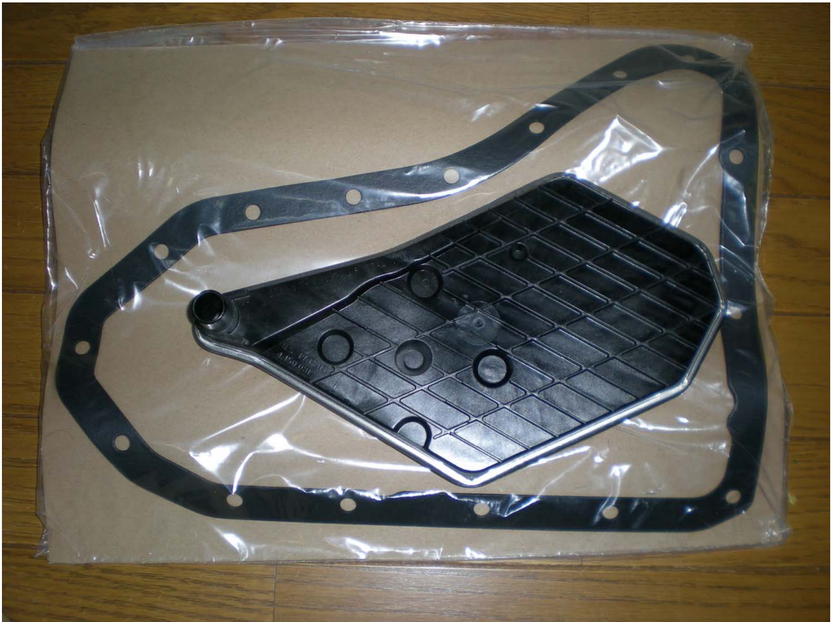
Delco製トランスミッションATFストレーナー/ガスケット
