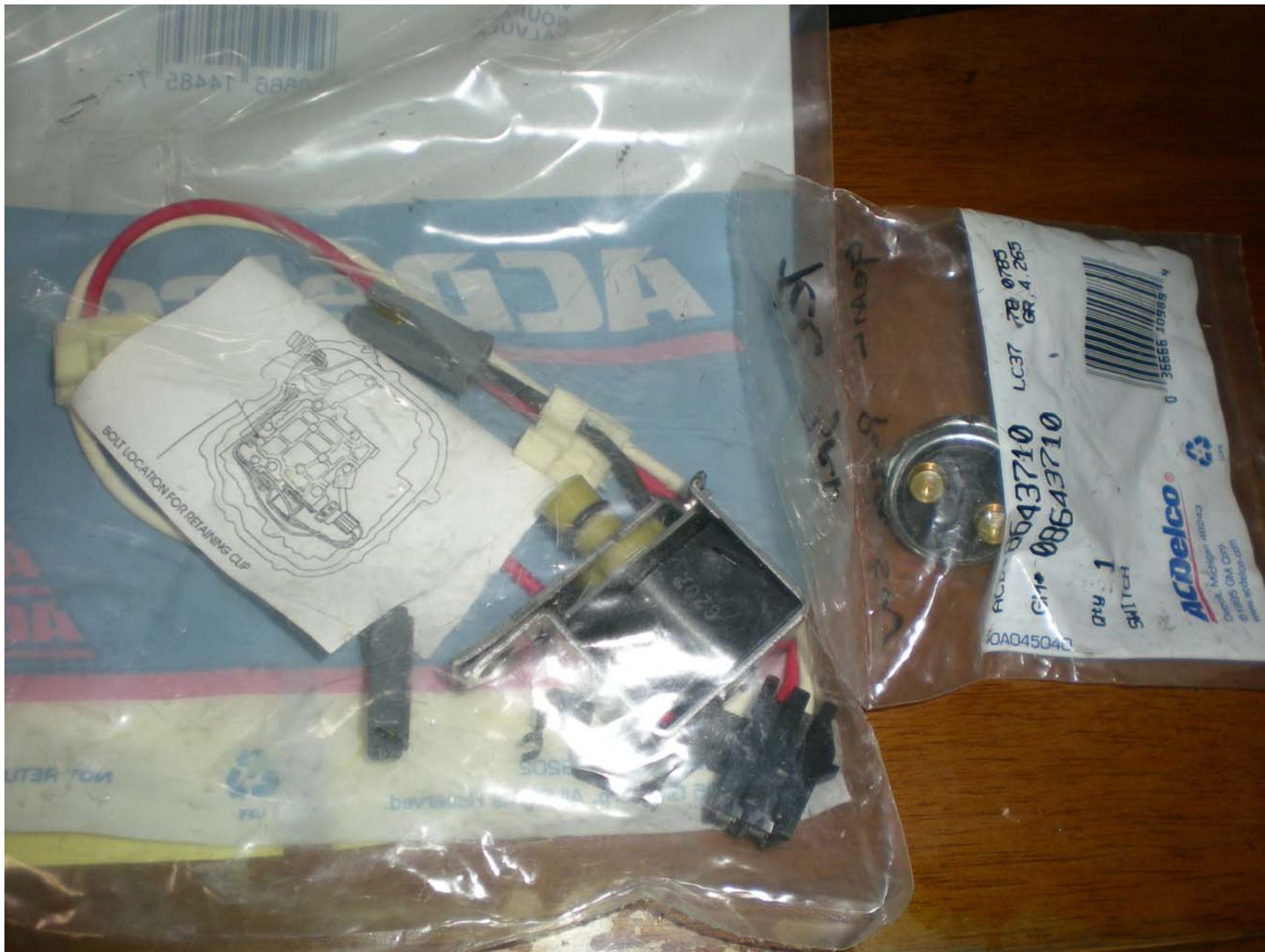
TCC Solenoid(左)と3rd Gear Pressure Switch(右)です。
