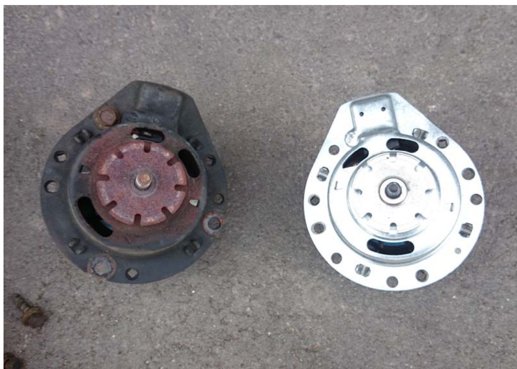
左が取り外したモーター。長い間ご苦労さまでした。 右が今回取り付け予定のモーター(Delco 15-8498)です。
