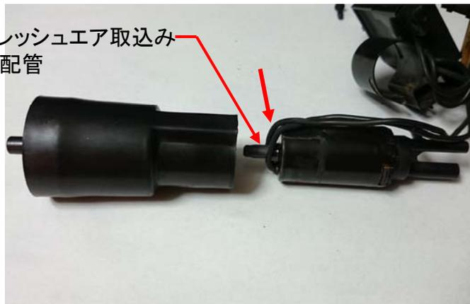
プラスチックのハウジングの中では、配線を配管の両側を這わせてわざわざ上から取り出すように取り回している。
