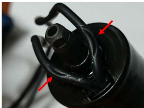
配管の両側を這わせて上から取り出したため、配線には「ドッキング」穴の壁に押さえつけられた跡が残っています…。
