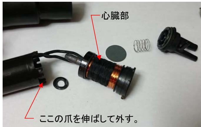
4 巻き線は腐食もなく、ほとんど新品同様です。右から、バキュームポート、スプリング、ブロックオフプレート、巻き線付き配管、Oリング、鉄製のカバーです。
