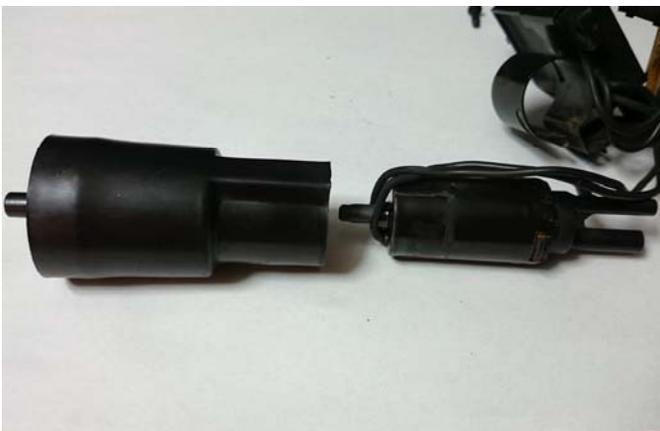
3 ドライヤーで暖めてプラスチックのハウジング(左)を取り外す。
