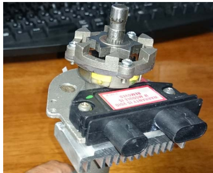
斜め上から。ICMIはリビルトディストリビュータ付属品。Fieroに装着する場合は、Delco製に交換した方がいいです。
